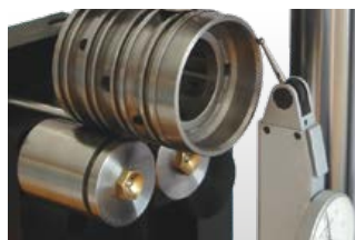
Mesure du battement axial
