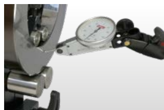
Mesure du battement axial
