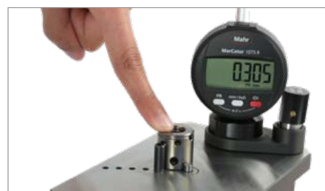
Mesure d'un chanfrein extérieur
