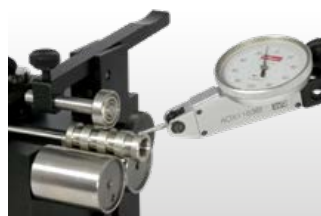
Mesure du battement axial
