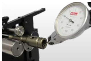
Mesure du battement axial
