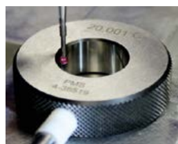
Étalonnage bague lisse sur banc SIP
