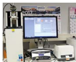
Étalonnage comparateur sur banc automatique
