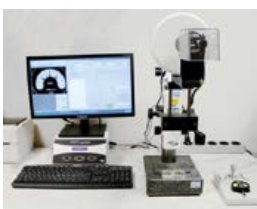
Étalonnage comparateur avec système caméra
